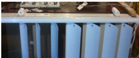
Figura 13. Posicionamento dos sensores LDR externos.
